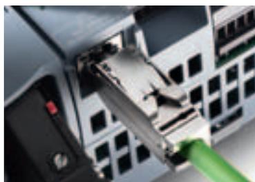
El PROFINET IO-Controller posibilita la conexión de equipos PROFINET. La interfaz PROFINET integrada puede usarse indistintamente para la programación
